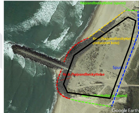
Figur 7: Illustration af designvandsstand inkl. bølgestuvning (2,93 mDVR90). Blå farve indikerer vand. (SCALGO, 2022)
